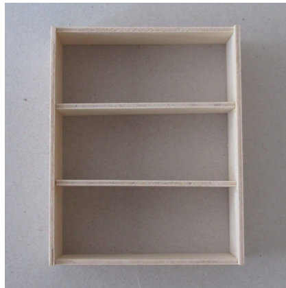
Billede 2: De to dele er limet sammen og de to hylder er sat i.
